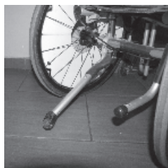
zdj.: zabezpieczenia przeciwwyrotne
